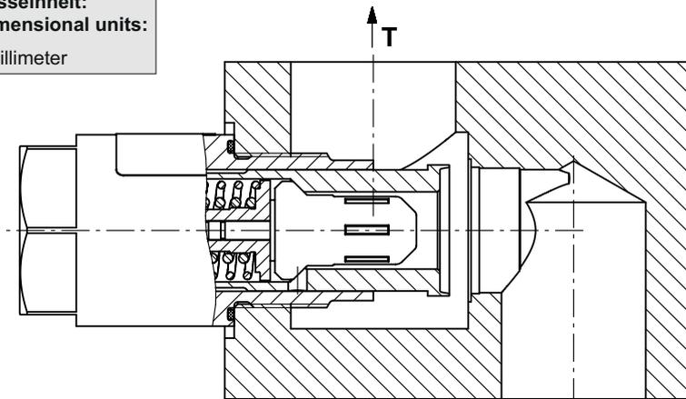
Thermoelement < 50 °C – Verbindung P nach T offen/
