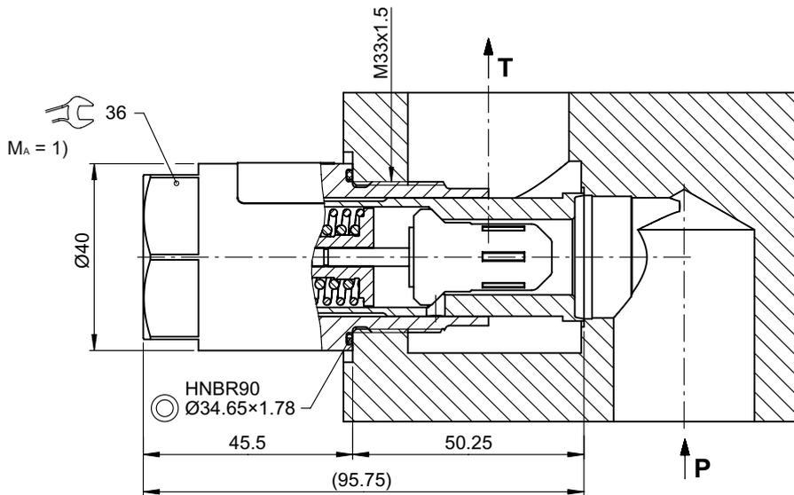
Thermoelement > 65 °C – Verbindung P nach T geschlossen/
