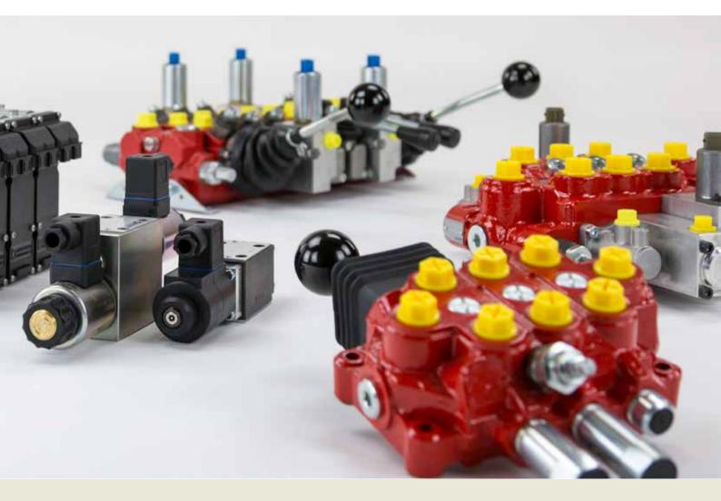
滑阀式方向阀主要使用在行走液压设备上的控制和安全作用。它有多种不用的设计和功能,例如:压力补偿器,防冲击阀,补油单向阀,溢流阀和流量阀,通过不同的配置可以满足各种不同的使用要求。
