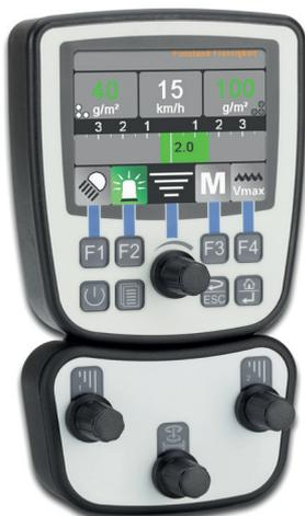
Mit den unteren drei Drehstellern werden die Förderleistung und die Streubreite eingestellt. Durch Drücken des oberen Drehtasters schaltet man zwischen der Streubildeinstellung und Laugenpumpeneinstellung um.
