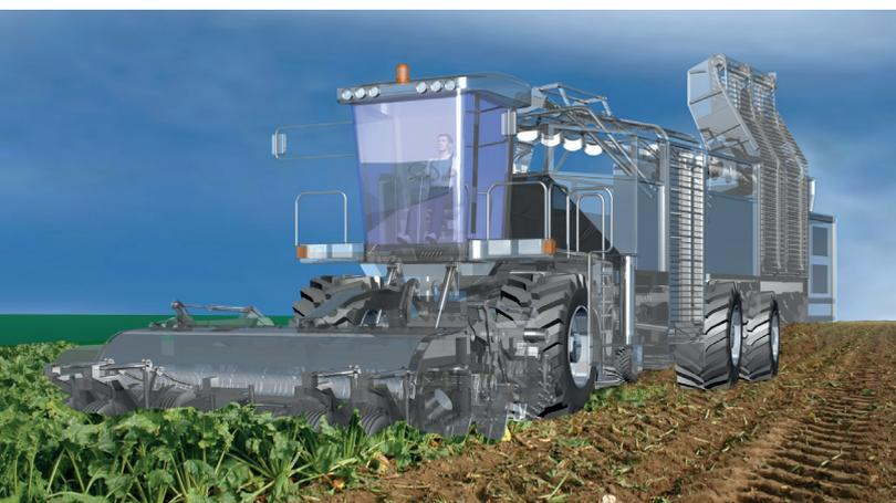
Erntemaschinen wie der Rübenroder müssen sehr präzise und schnell angepasst werden. Das LCV mit CAN-Aktuator bietet neben der hohen Regelgüte zur Tiefenregelung auch die exakte, feinfühlig Positionierung von tonnenschweren Überladebändern und übernimmt die Lenkung der Vorderachse beim Fahren in der Reihe, was den Fahrer deutlich entlastet.
